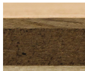
Modernes Fertigparkett mit maßhaltiger und dimensionsstabiler Mittellage aus Spezial-HDF
